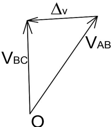
Le tracé de droite est obtenu en portant à partir d'un point fixe O des vecteurs proportionnels aux vitesses aux différents points de l'orbite de la planète :  $\vec{OV}_{AB} = k \vec{v}_{AB} = k \vec{AB} = k \vec{AD}$ . La courbe ainsi obtenue est l'hodographe de la
