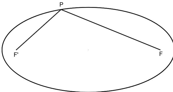
Les extrémités d'une ficelle de longueur donnée sont fixées en 2 points F et F'. L'ellipse peut être dessinée avec un crayon par exemple. La ficelle étant tendue, le point P décrit l'ellipse dont les foyers sont F et F'. En d'autres termes : l'ellipse est le lieu des points P du plan tels que  $PF + PF' = 2a$ .
