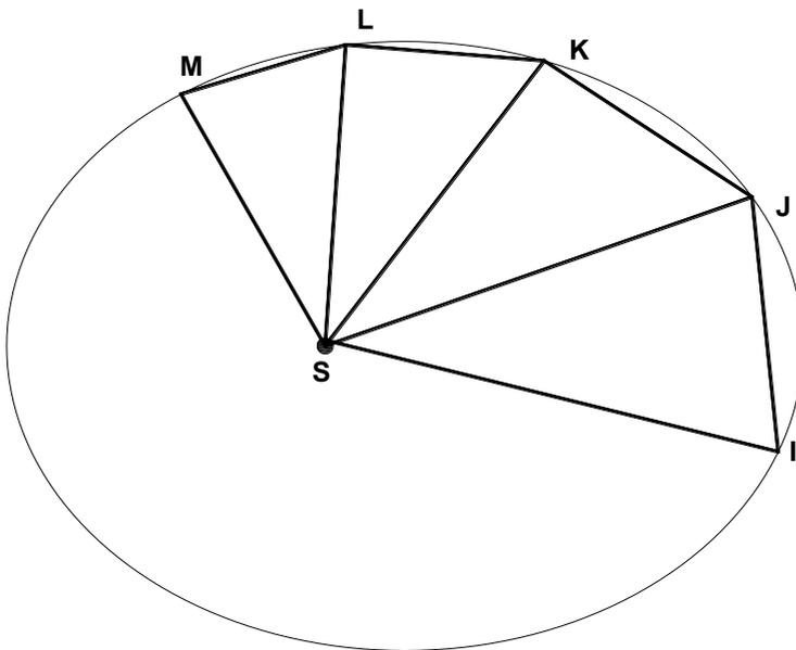
Les vecteurs-vitesses sont portés par les segments joignant les points successifs du polygone. Les vitesses ne sont plus proportionnelles aux longueurs des segments parce que les temps de parcours sont différents d'un segment à l'autre. Les angles entre les segments successifs SI, SJ, SK, etc...sont tous égaux à  $\alpha$ .
